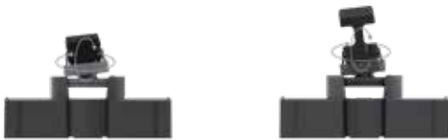
Bewegliche Aufnahme durch Kugelpfand
